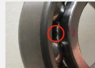
Lagerschaden am Innenring
